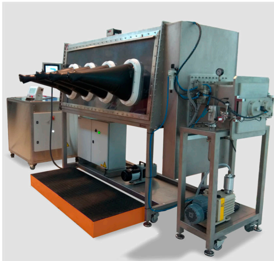
7-Cabina de guantes con unidad de purificación.
