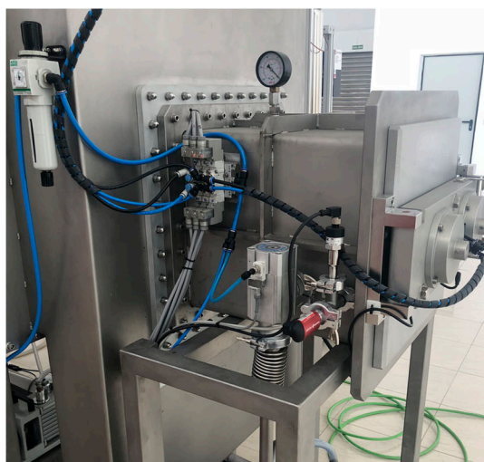
4-Antecámara con puerta exterior semi-automática y puerta interior automática, ambas con bloqueo neumático.
