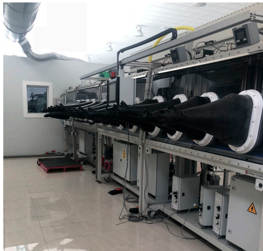
2-Cabina de guantes automatizada de 12m conectada a sala seca de 200m 2 .
