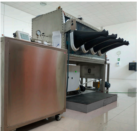
5-Cabina de guantes con unidad de purificación de H 2 O y O 2 .
