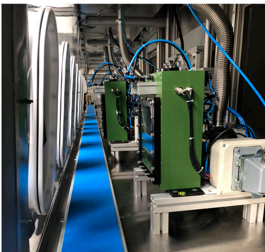
3-Ejemplo de utillajes para la fabricación de celdas de baterías dentro de una cabina de guantes.
